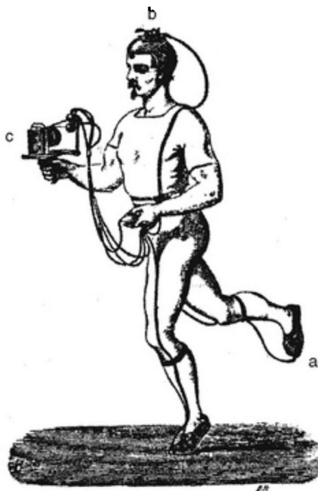
FIGURA 15-2 Os calçados instrumentados de Marey utilizados para a medição da marcha.
