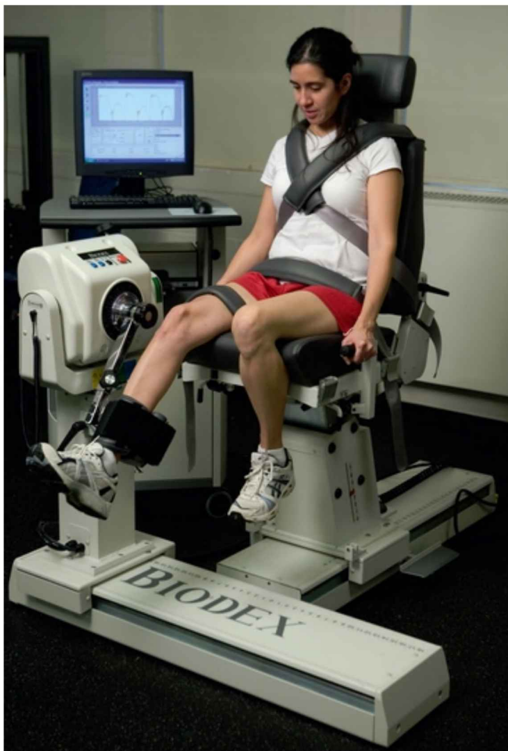
FIGURA 4-26 Um dinamômetro isocinético. O indivíduo gera um torque de extensão do joelho em esforço máximo com uma velocidade angular articular de 60 graus/s. A máquina funciona em seu “modo concêntrico” e fornece resistência contra o músculo quadríceps que se contrai no joelho direito. Observe que o eixo de rotação mediolateral do joelho testado está
