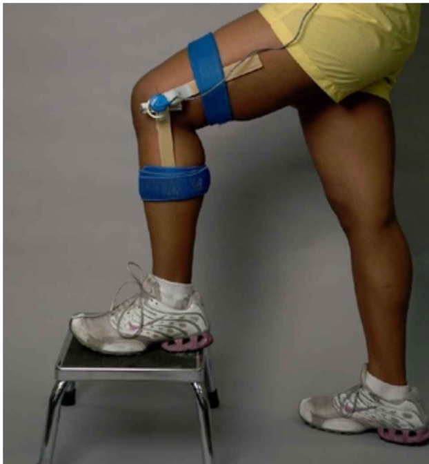
FIGURA 4-23 Um eletrogoniômetro é mostrado preso à coxa e à perna. O eixo do goniômetro contém o potenciômetro e é alinhado sobre o eixo mediolateral de rotação na articulação do joelho. Este instrumento em particular registra um plano único de movimento apenas do joelho.
